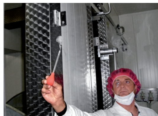
Visualisierung der Luftströmungen zwischen unterschiedlichen Hygienebereichen
