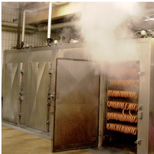
Unkontrolliert austretende Schwaden im Produktionsprozess
